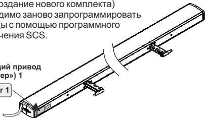
При вертикальном применении тяги (например, на чердачном окне) при необходимости следует отрегулировать усилия с помощью программного обеспечения SCS.
